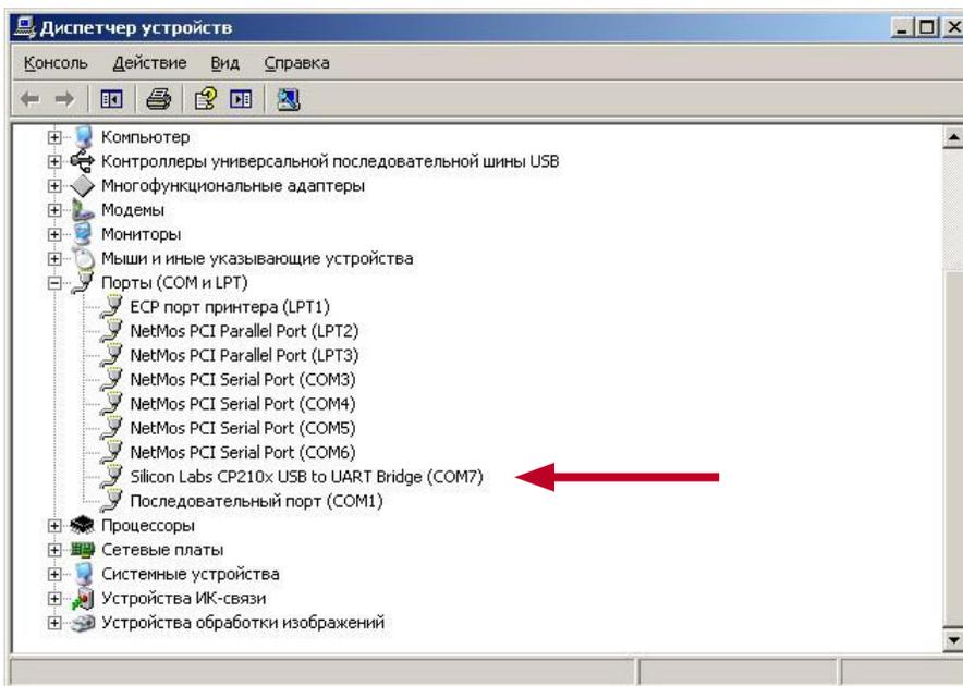
Закройте диспетчер устройств. Подключите COM разъем от NAVIgard 1425 к устройству, с которым предполагается работать. В программе, с которой предполагается работать выберите тот COM порт, который появился в диспетчере устройств при подключении переходника.
